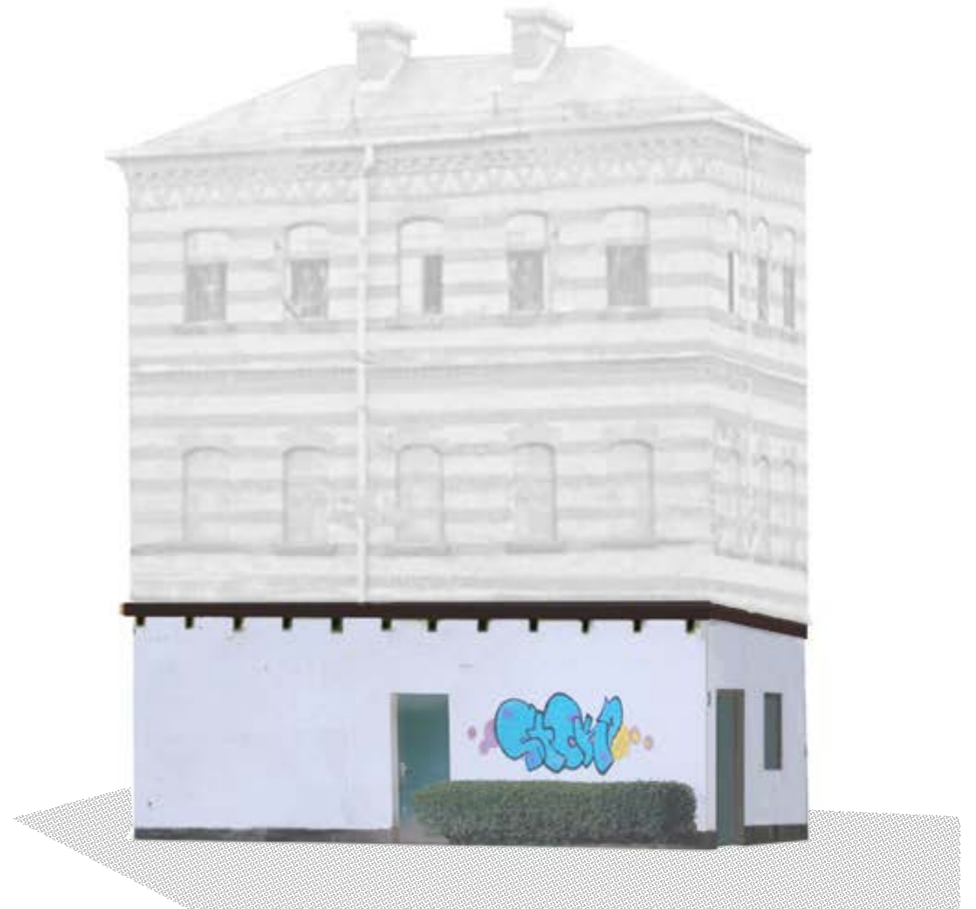
ABRISS DER BEIDEN OBEREN GESCHOSSE
